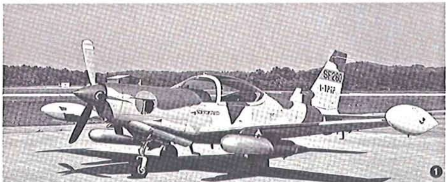
Fig. 1 - Aereo d'addestramento SIAI Marchetti SF 260 TP. È visibile la marmitta inox sotto la parte anteriore.
